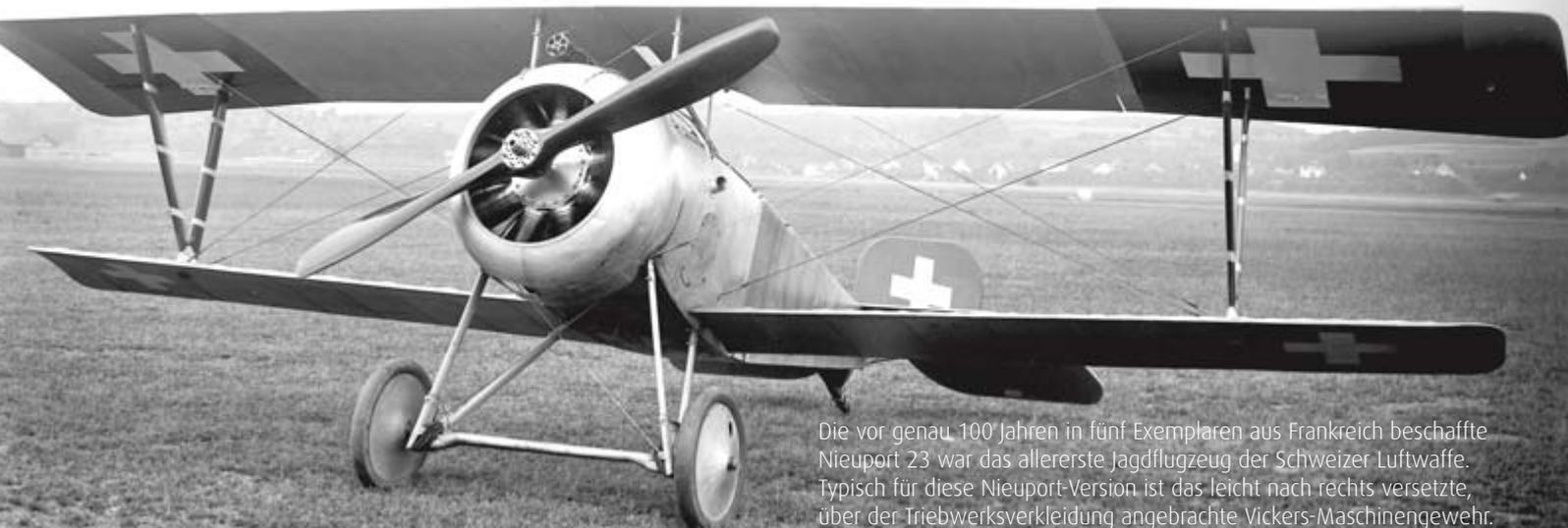
Die vor genau 100 Jahren in fünf Exemplaren aus Frankreich beschaffte Nieuport 23 war das allererste Jagdflugzeug der Schweizer Luftwaffe. Typisch für diese Nieuport-Version ist das leicht nach rechts versetzte, über der Triebwerksverkleidung angebrachte Vickers-Maschinengewehr.
