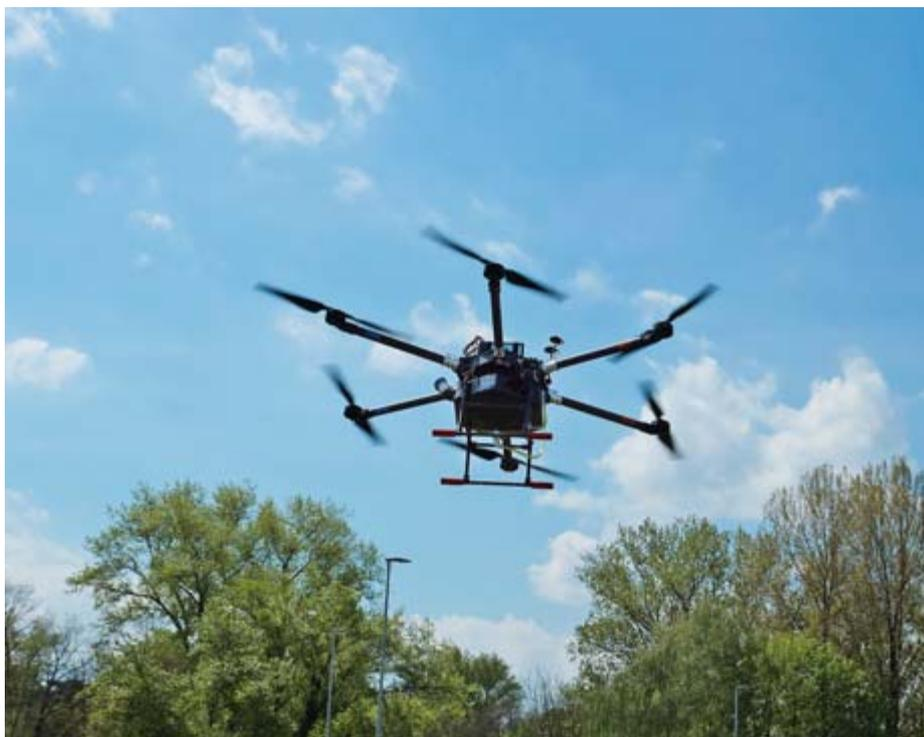
Oben: Demonstration einer Drohne, die speziell für Sprühflüge in den Rebbergen eingesetzt wird. Unten: Pilotiert wird die Drohne mit Hilfe einer Konsole.
