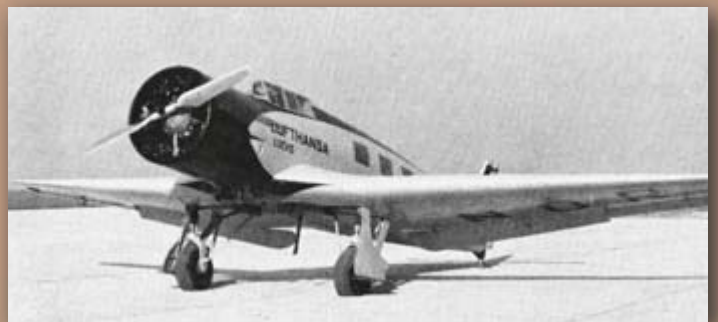
Die Junkers Ju 160 war 1934 die deutsche Antwort auf die amerikanische Lockheed Orion. Typische Merkmale: Einziehfahrwerk, komfortable Kabine für sechs Passagiere und geschlossenes Cockpit.
