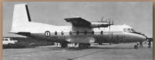
Als Ersatz für die weit verbreitete Douglas DC-3 produzierte die französische Luftfahrtindustrie die von zwei Propellerturbinen angetriebene Nord 262 für 26 bis 29 Passagiere.
