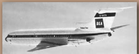
Der Hawker Siddeley Trident Two (2E) wurde für die British European Airways BEA speziell für die Verbindungen in den Nahen Osten entworfen und war mit einem automatischen Landesystem ausgerüstet.
