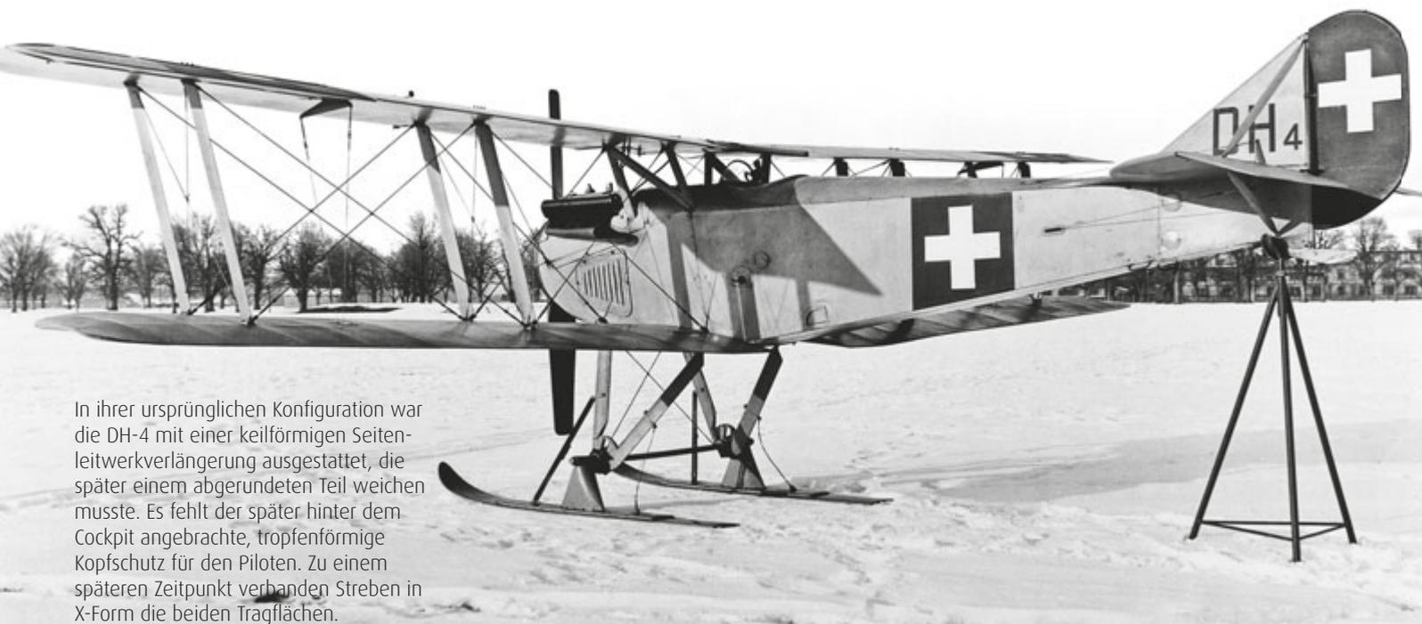
In ihrer ursprünglichen Konfiguration war die DH-4 mit einer keilförmigen Seitenleitwerkverlängerung ausgestattet, die später einem abgerundeten Teil weichen musste. Es fehlt der später hinter dem Cockpit angebrachte, tropfenförmige Kopfschutz für den Piloten. Zu einem späteren Zeitpunkt verbanden Streben in X-Form die beiden Tragflächen.
