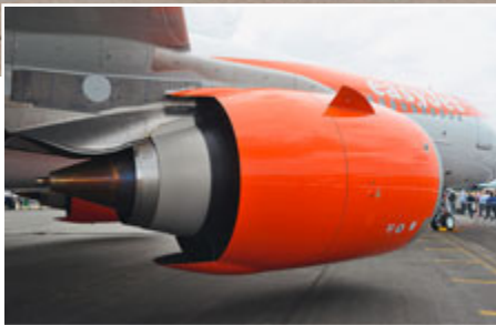
Das exklusiv für A320neo und A321neo gebaute CFM LEAP-1A-Triebwerk.
