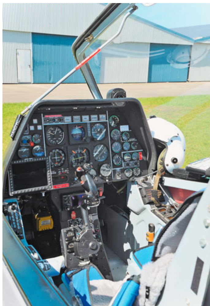
Das Fantrainer-Cockpit ist noch analog. Eine mögliche Fanjet-Avionik wäre als Glascockpit konzipiert.
