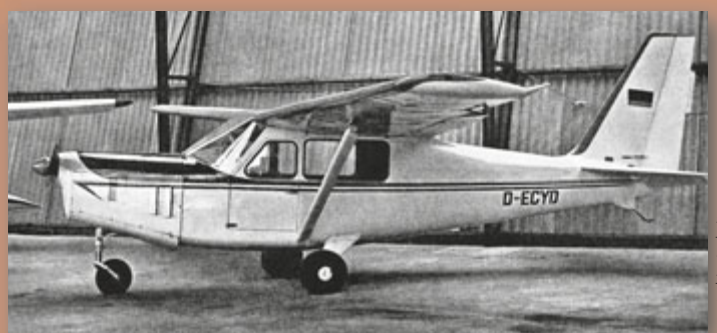
Der für seine Segelflugzeuge bekannte Hersteller Schempp-Hirth baute einen einzigen Milan GS.6a mit einem 105-PS-Walter-Minor-4-III-Motor.
