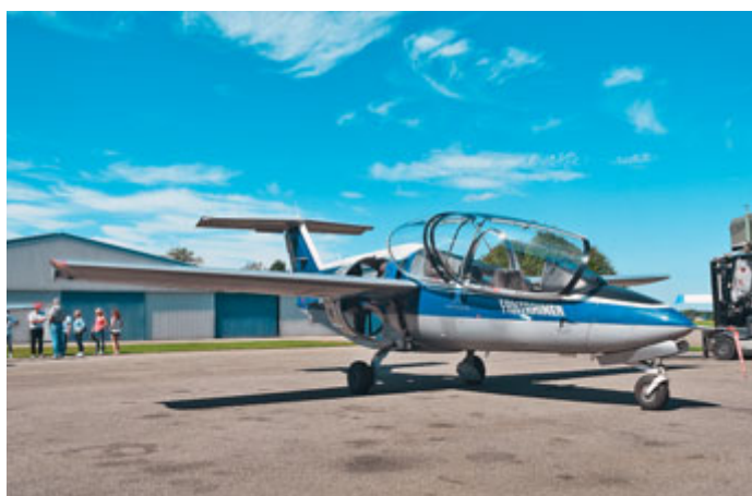
Der Fantrainer 400 wird von einer schwächeren Allison-Turbine als die spätere Version 600 angetrieben.
