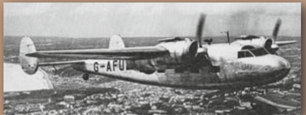
12 bis 17 Passagiere fanden im De Havilland D.H. 95 Flamingo Platz. Die Reisegeschwindigkeit betrug 296 km/h.
