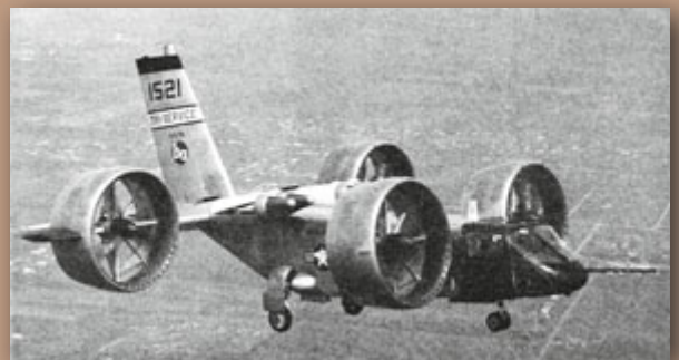
Der Senkrechtstarter Bell X-22A mit vier Schwenkpropellern an den Flügelenden flog 1966 erstmals.
