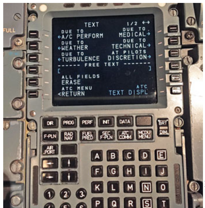
Controller-Pilot-DataLink-Communication ermöglicht störungsfreie Kommunikation zwischen Pilot und Fluglotse.
