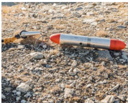
Der Hit-Indikator misst den Überschallknall und überträgt den Wert auf die Auswertanlage.
