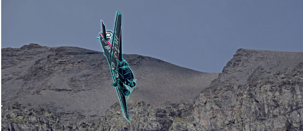
Abbildung 7: Bild der HB-HOT bei Punkt F16 mit überlagertem dreidimensionalem Modell einer baugleichen Ju 53/3m g4e (hellblau) zwecks Bestimmung von Lagewinkeln, Flügeldurchbiegung und Ruderausschlägen. Die Blickrichtung zeigt nach Nordosten, im Hintergrund ist der südliche Ausläufer des Piz Segnas erkennbar.
